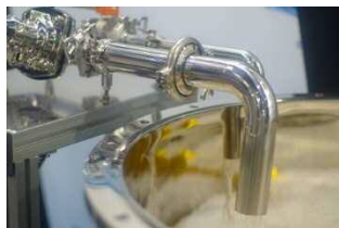
さまざまな形のスイベルジョイント製品がございますので、柔軟に配管が可能です。
