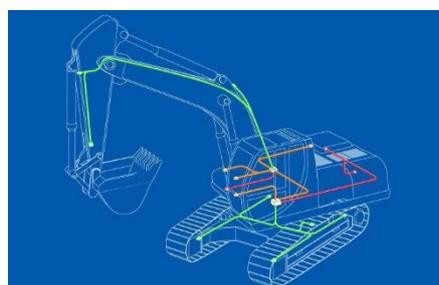
\*ワイヤーハーネス：複数の電線を束にしたもので（人間で例えると血管のような役割。非常に複雑で繊細。）電源供給や信号通信に用いられ、自動車やバイク、建設機械に使用される部品。
