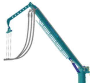
アンモニア用バンカリングブームの3Dモデル
