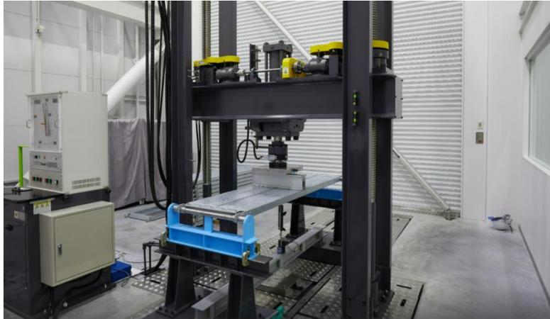
“安全の可視化”を通して、お客様に安全な仮設機材を提供するために実証実験を行うエリア。明確な耐久性の数値基準を設け、お客様へ安全な仮機材を提供するために研究を行います。廃棄の基準となる数値の根拠がなかった仮設機材。タカミヤは、実証データを数値化、可視化された入れ替え基準を作り「作って終わり、売って終わり」だった仮設業界を「安全の可視化」をキーワードに業界の慣習を変革します。より安全で信頼性の高い仮設機材の提供を実現し、業界全体の安全基準の向上に貢献します。
