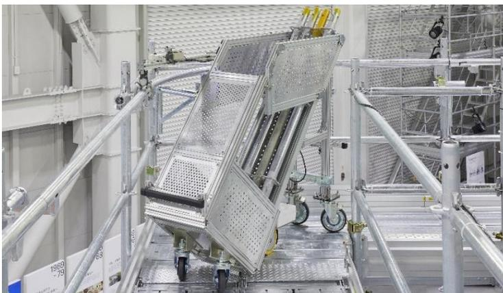
Innovation Hub 中央に位置するタカミヤのソリューションを提案する展示エリア。こちらでは足場内運搬システム「T-Rook」を紹介。約 70%は運搬作業が占めると言われる足場内作業。人手不足が叫ばれる建設業界へのソリューションとして、タカミヤは「ロボティクス」に着目し、開発に着手しました。このロボティクスは、最大 150kg の積載を可能とし、スピードは昇降で分速 20km、横移動で分速 4km（人が歩くスピード）です。今後も「省人省力化」「生産性向上」をキーワードに研究開発を進めてまいります。
