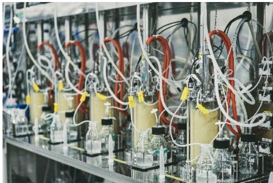
Spiber 本社ラボにおける小規模微生物培養装置
