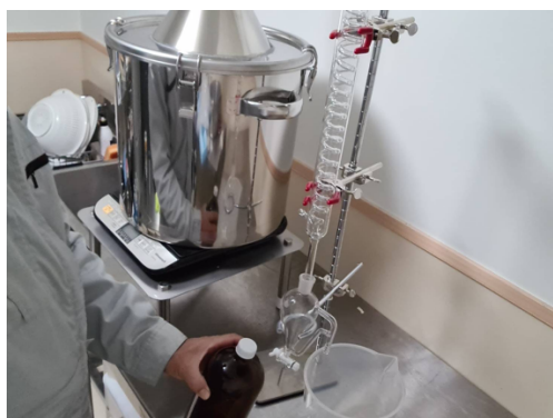
精油の蒸留設備
