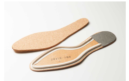
↑フレキシブルグッドイヤーウェルト製法 ↓通常のグッドイヤーウェルト製法
