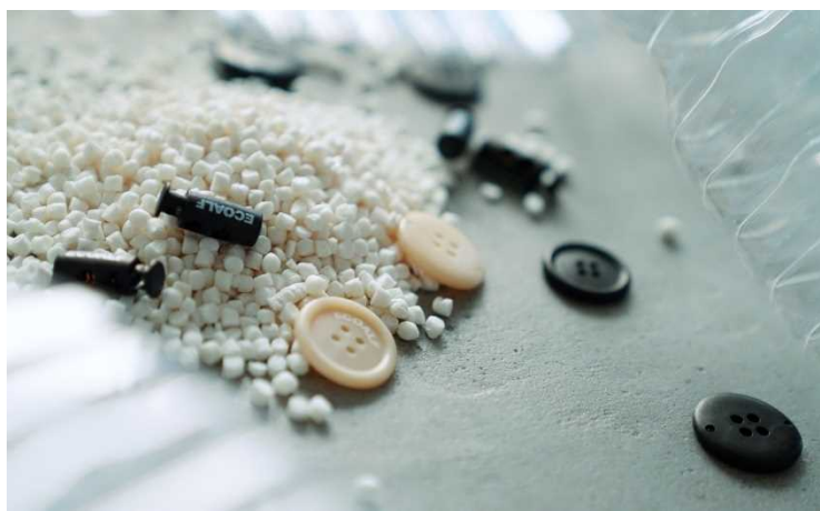
パナソニックと共同開発した環境負荷の低い材料による 釦とスピンドルストッパー(白い粒は kinari のペレット)
