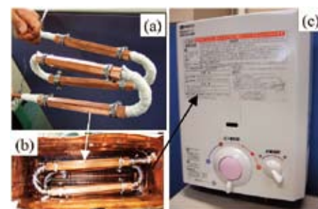
▲酸化物パイプ型モジュール(a)と湯沸かし器燃焼室(b)、それらを搭載した湯沸かし器(c)。(株)ノーリツと共同制作。
