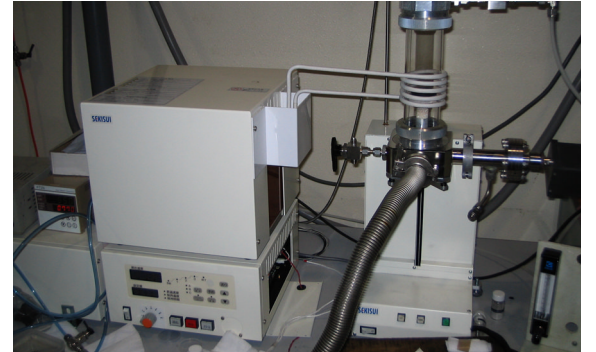
▲カーボンオニオンを生成する高周波誘導加熱炉。ダイヤモンドナノ粒子またはカーボンブラックを不活性雰囲気中で高速加熱(最高加熱温度: 約2,500°C)することにより生成する
