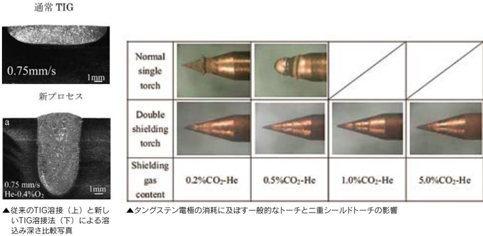
▲従来のTIG溶接(上)と新しいTIG溶接法(下)による溶込み深さ比較写真
