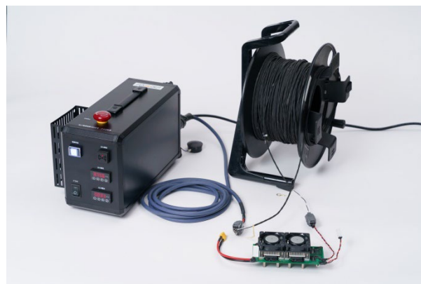
フカデンが開発したドローン向け有線給電ユニット「電源制御BOXIIメイン電源ユニット」(写真左奥)と Vicor の DCM シリーズを 2 つ採用したドローン搭載電源部分 (写真右前)
