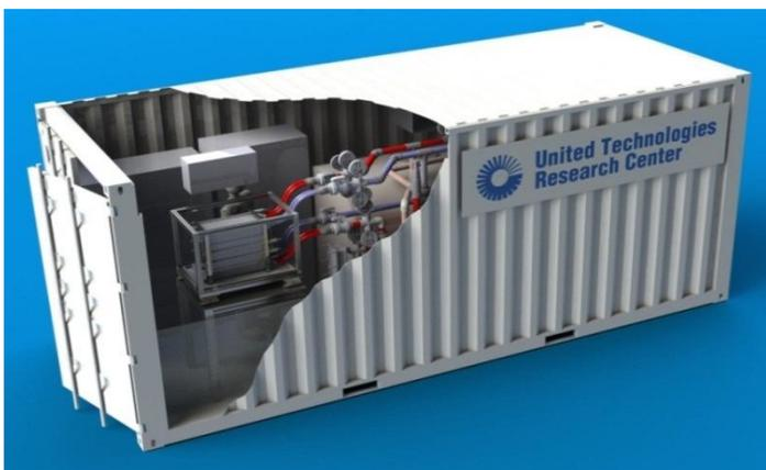
PureStorage システムは、顧客のもとでいつでも設置・稼働できることを示すため、標準的な 20 フィート(約 6 m)の輸送コンテナ内にパッケージされています。このデモ用システムは現在 UTRC に設置・接続されており、事業用建物への応用が可能なことを示しています。
