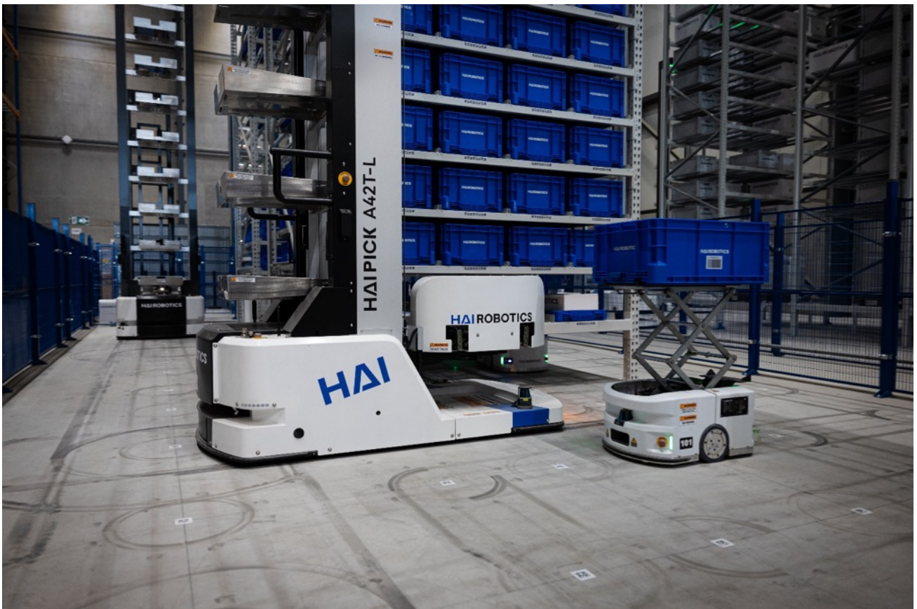
HaiPick System3：伸縮式グラブブルック ACR(HaiPick A42T-E2)(左)とAGV(K50 自律移動ロボット)(右)が連携する様子
