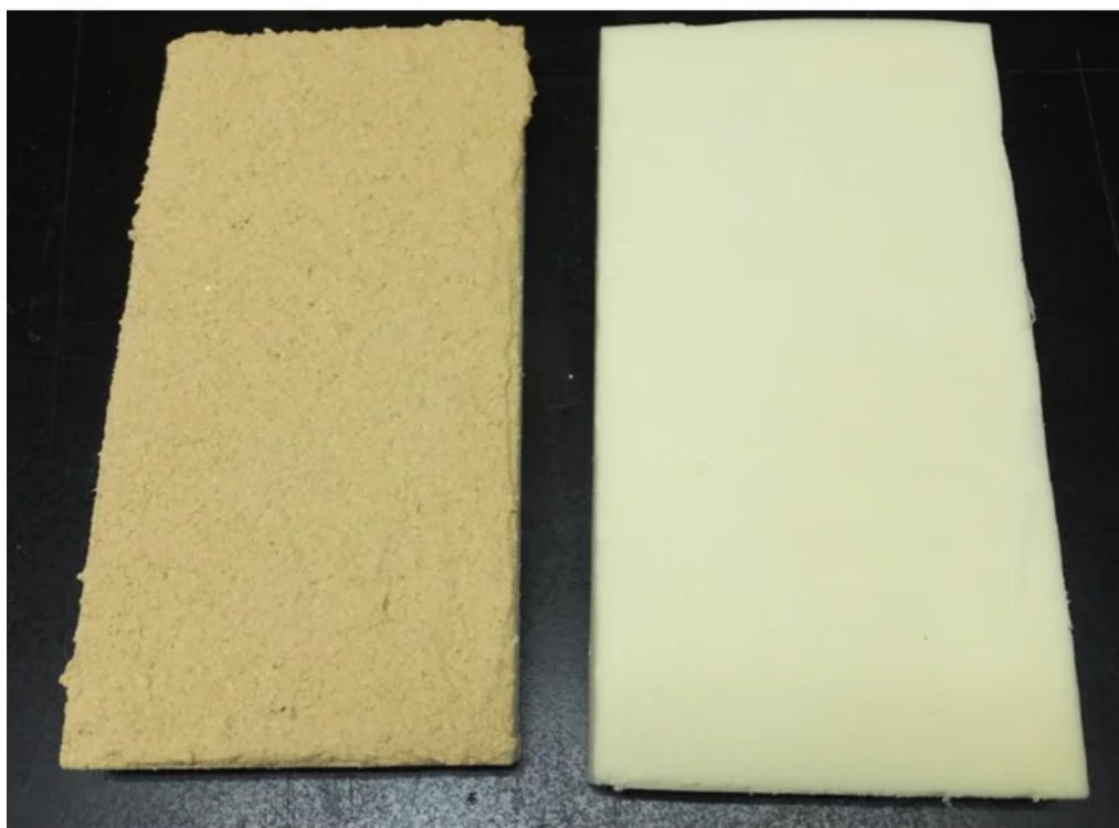
左：発泡ウレタン断熱材（硬質ウレタンボード）に不燃木粉を加工したサンプル 右：未処理の発泡ウレタン断熱材
