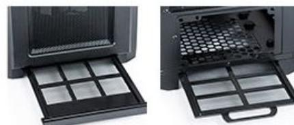
前面、天面、底面にはホコリを防ぐフィルターがあり、底面のフィルターは簡単に引き出し、清掃も簡単。
