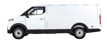
・サイドア開口高さ:905mm・サイドア開口幅:765mm・荷室フロア長:2890mm
