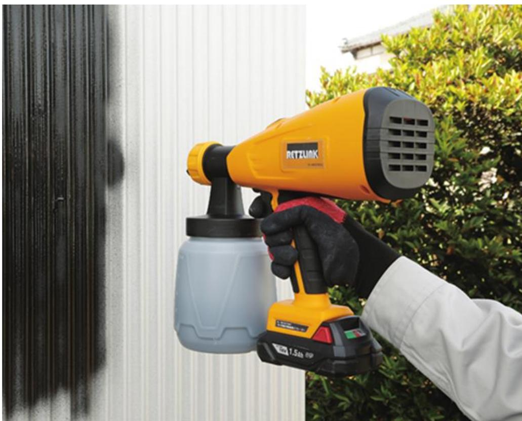
小さな部品はもちろん、DIYで制作した家具の塗装など、幅広い用途に使えるのが魅力のスプレーガン。霧状にした塗料を噴射して、スピーディーに着色します。ブラシやローラーでの塗装に比べ、手早く均一に仕上がるので、DIYで課題になりやすい、色ムラを無くすことができます。
