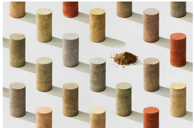
<版築ブロック>
