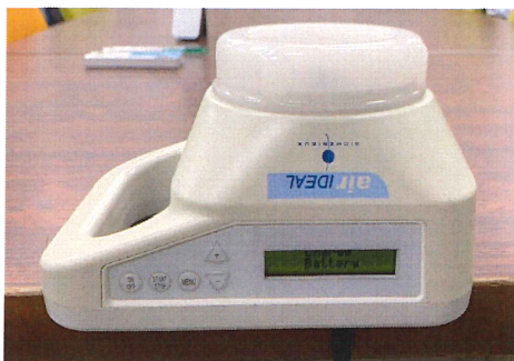
写真1:エアースンプラー
