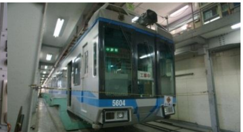
全般検査中の湘南モノレール
