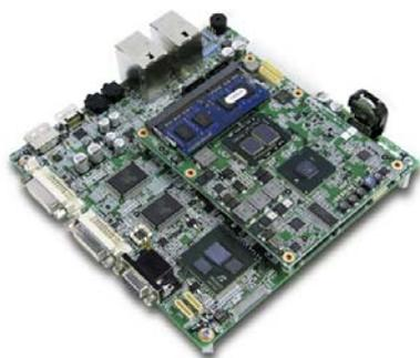
アクセル社グラフィックスLSI「AG10」と、組み向けインテル® アーキテクチャーを組合わせた、多画面(マルチディスプレイ)ソリューション対応の開発用ボードシステム。数多くの高速インターフェースを搭載しながらも、6層構成でかつMini-ITX(170x170mm)というコンパクトなサイズを実現しました。
