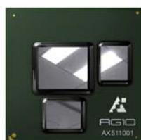
512Mbit のビデオメモリを搭載し、最大 4 画面まで出力表示ができる高速 2D グラフィックス LSI です。また、高いグラフィックス性能を持ちながらも、低消費電力駆動でヒートシンクレスを実現しています。
