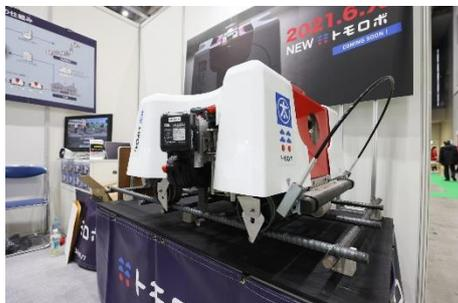
「世界一ひとにやさしい現場を創る」をビジョンとしているロボットメーカー・建ロボテックは、鉄筋を結束するという作業から職人を解放し、作業を効率化する自走型協働ロボット「トモロボ」を展示。
