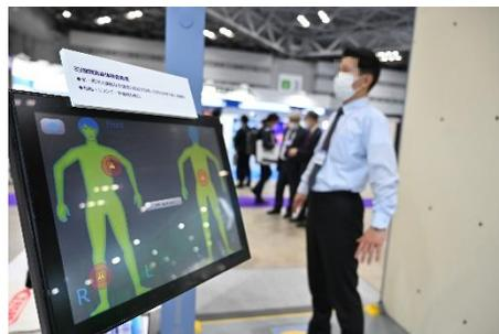
リスクマネジメント対策としての統合セキュリティシステムを紹介。目玉展示の 1 つである「QPS (Quick Personnel Security Scanners)」は、金属探知機で発見できる持ち込み禁止物だけでなく、プラスチック・セラミック製の凶器や爆発物（有機物）、可燃物（液体やジェル）・粉末、紙幣などの所持の検知が可能で、企業の機密データ流失も未然に防ぐシステムです。わずかハンカチ 1 枚程度の厚さでも感知することが可能です。2 枚のパネル間で超低強度ミリ波信号を発射・解析することで高性能な検知を実現、約 1 秒未満で検査が完了するため、検査対象者の負担が最小限です。
