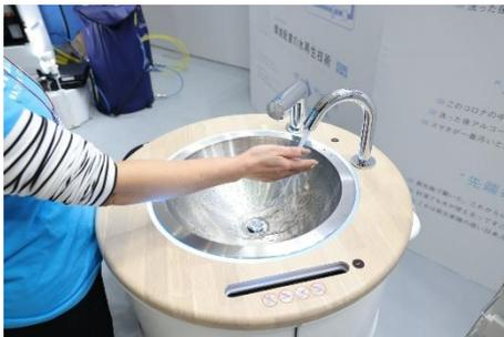
WOTAではAI水循環システムを紹介。1L/分の供給水量を誇る大型の水浄化システム「WOTA BOX」と、スマートフォン除菌機能を搭載する手洗いスタンド「WOSH」を展示。ブースでは「WOSH」で実際に手を洗ったり、スマートフォンを除菌する体験が可能です。独自の水処理を採用し、不純物を99.9999%以上除去したキレイな水を提供し、さらに、最先端のAI水処理技術により、一度使った水の98%以上が再利用できます。水道設備が不要なため、飲食店の受取場所・商業施設の出入口・医療施設や、地震や台風被害といった、災害時などにおいてすでに活用されています。
