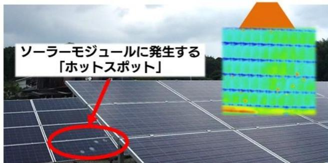
ソーラーモジュールに発生する「ホットスポット」の現象は、モジュール破損の原因となり、発電事業の運営コストにインパクトの大きな損失をもたらします。ホットスポットは、製造時のハンダ不良などの不具合、落ち葉などの付着が原因となり、その部分が発熱してモジュールの一部が破損する現象です。検査により「ホットスポット」を早期発見することで、発電量の低下や交換コストを抑制することが可能です。
