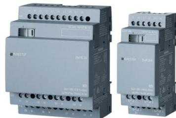
オートメーションプロジェクトの迅速な導入を実現するプログラマブル・ロジック・コントローラ (PLC) です。設計者はタイマ、スイッチ、タイマリレー、カウンタ、補助リレーなどの機能をすぐに実装できます。コンパクトなモジュラー設計により、コントロールキャビネットのスペースを節約し、簡単に統合できます。
