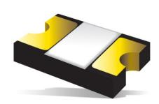
独自の freeXpansion™設計を採用し、小型 (0402) のフットプリントで高ホールド電流、高電圧、抵抗安定性向上を実現することで、性能を向上させています。 バッテリ充電や USB ポート保護など、スペースに制約のあるモバイルアプリケーション内での過電流と過温度上昇の両方の事象からの保護を目的として設計されており、PC のマザーボードのプラグアンドプレイ保護も提供します。
