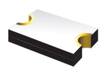
高温環境向けの製品で、定格電圧が 12V、最大入力電流定格が 40A で、薄型 (0603) デザインで提供されています。この製品は、自動組み立て用の表面実 装パッケージング、+125℃の最大動作温度定格、および低熱ディレーティング 係数を特徴としています。Bourns 独自の freeXpansion™設計による優れたヒューズ性能があり、高温での動作が求められる産業用やその他の要求の厳しいアプリケーションに最適です。
