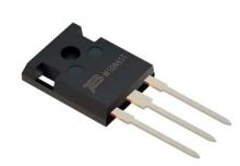
高電圧アプリケーション向けの製品で、スイッチモード電源 (SMPS)、無停電電源 (UPS)、力率補正 (PFC) などの高電圧/大電流アプリケーションに対応する MOSFET ゲートとバイポーラトランジスタのテクノロジーが組み合わせて採用されています。また、熱効率が高く、高度なトレンチゲート・フィールドストップ技術を利用して動的特性をより綿密に制御するので、コレクタ-エミッタ飽和電圧が低下し、スイッチング損失が減少します。
