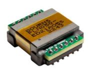
バッテリ管理システム (BMS) などの薄型かつ高電力密度が必須となる  $48W\sim70W$  のパワーオーバーイーサネット (PoE) の産業用アプリケーションを対象に設計された順方向コンバーター用トランスです。この製品は、スイッチング周波数 250kHz、電圧  $5V\sim12V$ 、出力電流  $4A\sim14A$  で動作し、電源管理と LED 照明の両方のアプリケーションに適しています。
