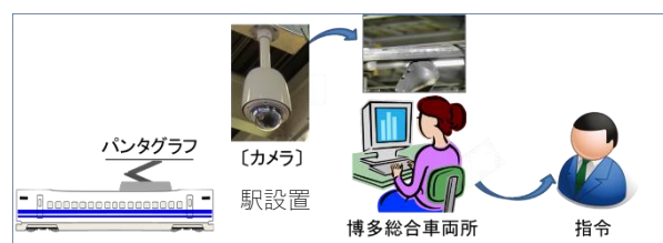
図 - 4 当番制でのすり板溶損監視(現行)
