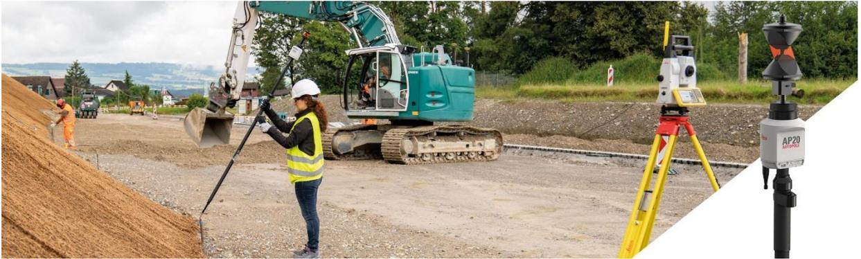
【2023年4月28日 東京】計測テクノロジー業界のリーダーであるライカジオシステムズ株式会社(本社:東京都港区、代表取締役社長:日比孝典)は、傾斜補正機能を備えたプリズムオートポール Leica AP20 AutoPole (以下 AP20) が国土交通省の「3次元計測技術を用いた出来形管理要領(案) 令和5年3月版」に新たに追加され、土工編及び舗装編内のそれぞれ面管理/断面管理にて TS 光波方式(傾斜補正機能付きプリズムを使用する場合)にて対応可能になったことを発表しました。
