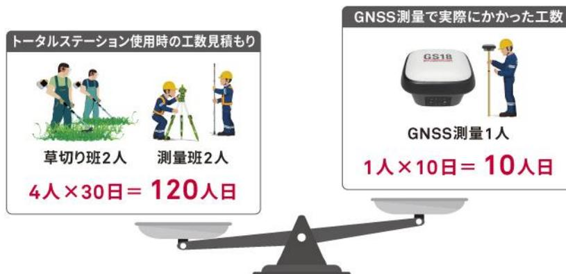
BMフィールドにおけるGS18 Tの導入効果は主に二つ上がっています。一つは最新技術によってGNSS測量を適用できる現場が広がり、最低人員で計測作業を完結できる仕事が増えたことでコスト削減につながったことです。もう一つの効果は、ポールの垂直維持に気を使うことなく高速に測量ができて、現場での作業工数が大幅に軽減されたことです。その結果、利益が増大しているだけでなく、「GNSS測量に強い会社」として知られるようになり、他社との差別化にもつながり、北海道以外の仕事を依頼されることも増えていると青山氏は述べています。
