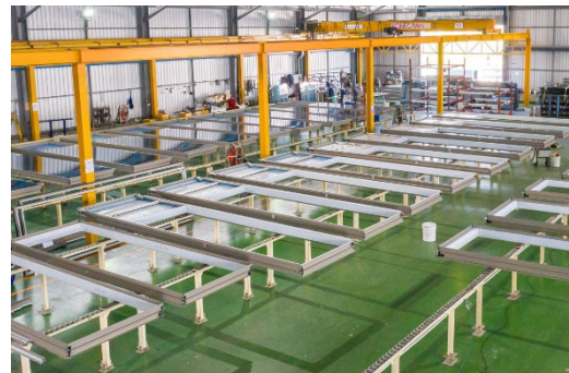
YHSI 工場 カーテンウォール組立工程
