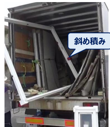
枠完成品出荷の場合、 トラックでの運搬時に斜め積みになる
