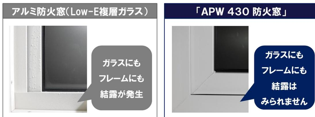
[結露試験条件] 室外温度0℃/室内温度20℃/相対湿度:60%、たてすべり出し窓06011サイズ
