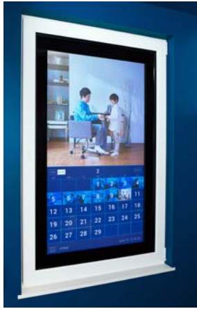
窓が毎日の生活を記録して 行動パターンに応じ窓を自動開閉
