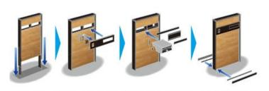
①柱の埋込み。 ②インターホンカバーや ③照明、インターホン結絡。 ④幅木の取付け。 インターホンの取付け。 ポスト、背面カバーの取付け。
