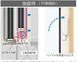
戸車が倒れ障子が室外側に引き寄せられエアタイト材と密着することで気密性能を高めます。
