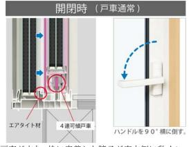
戸車が立ち、枠に密着した障子が室内側に動くことでエアタイト材から離れ開閉が軽くなります。
