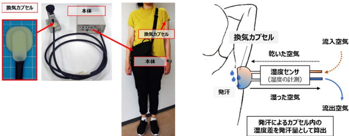
図5 日常行動時のワキ発汗の測定に適した評価機器
