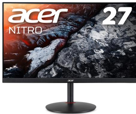
「XV270Pbmiiprfx」は、細部まで鮮やかに表示するフル HD(1920×1080) IPS パネルを採用。応答速度は 0.5ms<sup>※2</sup>と速く、動きの速いゲームの再生時などに発生する残像を抑えます。画像の滑らかさを左右するリフレッシュレートは、オーバークロック時は最大 165Hz と高く、AMD FreeSync™ Premium テクノロジーにも対応。画像の表示遅延やカクツキを最小限に抑え、安定したゲーム環境をお楽しみいただけます。また、広い輝度幅で、明るい部分と暗い部分のコントラストをはっきりと表示する HDR 10 の規格にも対応しています。
