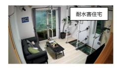
一般的な住宅のリビング(画像左)は浸水し、家具も流されてしまっていますが、耐水害住宅(右)は浸水することなく普段通りのリビングを保っています。(「耐水害住宅」の実物大建物浸水実験にて)
