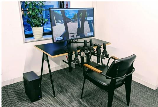
建機等の大型機械の実証実験する際の事故発生リスクを低減するために、現場環境を再現するためのシミュレータを国内で開発しました。
