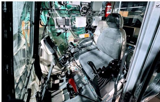
レガシーな建機にも後付け搭載可能な遠隔操作装置です。
