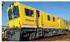
軌道専用の検測車 既設の検測機能を搭載する検測車は、軌道の検測に特化したタイプ。検測機能は、軌道の検測を主とする。検測機能は、軌道の検測を主とする。検測機能は、軌道の検測を主とする。
