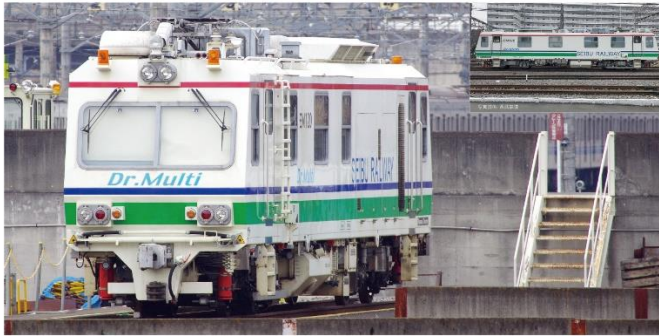
軌道専用の検測車 既設の検測機能を搭載する検測車は、軌道の検測に特化したタイプ。検測機能は、軌道の検測を主とする。検測機能は、軌道の検測を主とする。検測機能は、軌道の検測を主とする。
