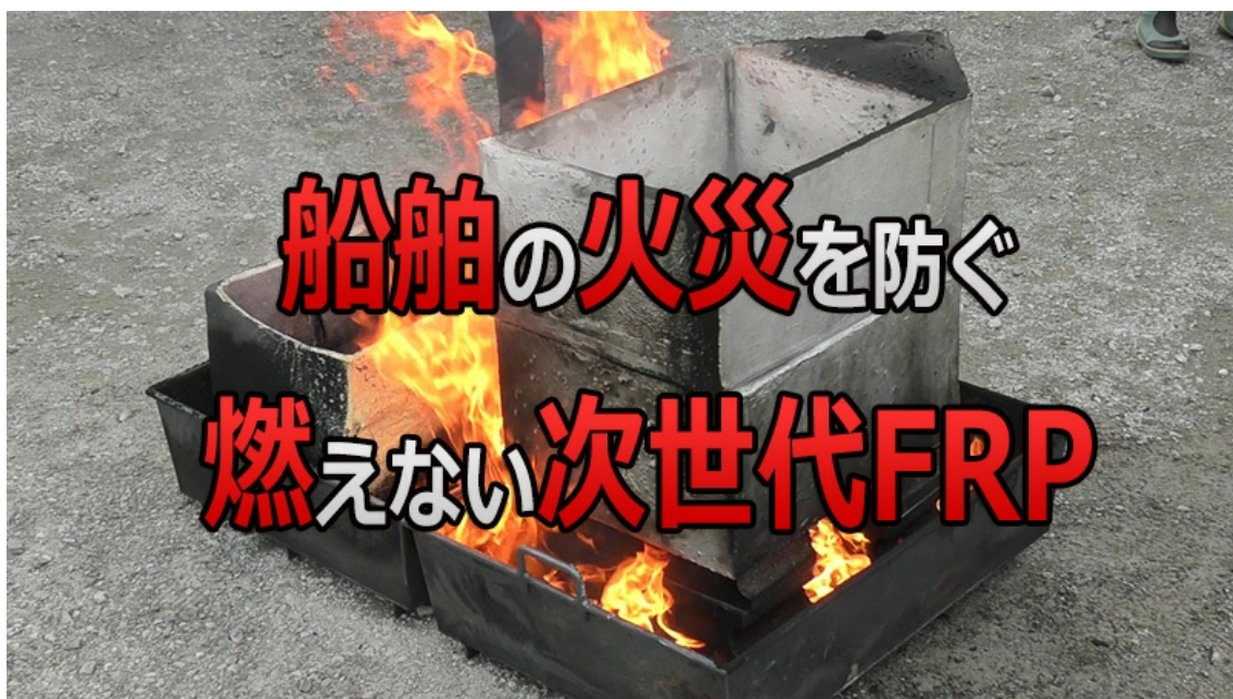
船舶火災を防ぐ燃えない次世代FRPの燃焼実験（3月24日青森県の小泊漁港）
