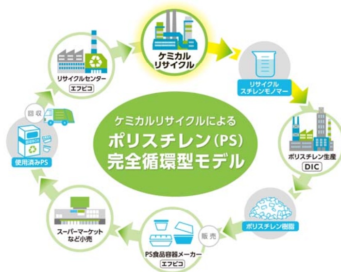
「ケミカルリサイクルによるポリスチレン(PS)の完全循環型モデル」
