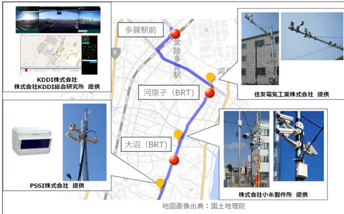
図 3. 路側センサーの設置個所と設置物
