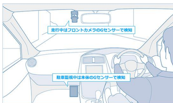
【車の状況に応じて2つのGセンサー(フロントカメラ/本体)で車の衝撃を検知】
