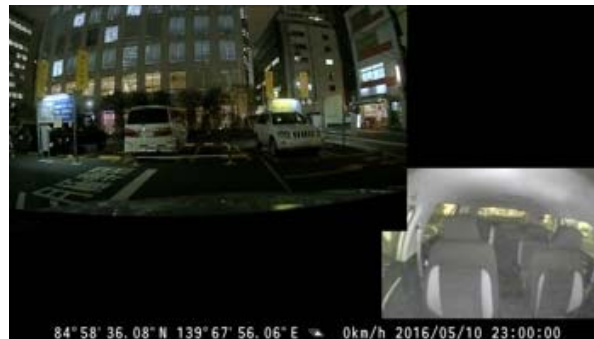
【フロアカメラユニット接続時には、車内外を同時に撮影】
