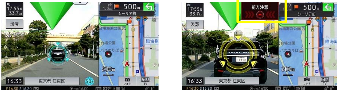
【ターゲットスコープの色の変化や警告音、画面表示で注意を促します】
