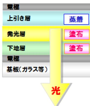
【「蒸着成膜プロセス」と「塗布成膜プロセス」の違い】
