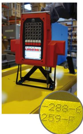
SIC マーキング社の電磁式ドットマーキングマシンは、電源以外の動作源（エア、油圧等）を必要とせず、樹脂からHrc62の鋼鉄まで様々な材質に対応。自動車のエンジブロック、シリンダーヘッド部などへバラツキの無い高品質なマーキングが可能です。パーマネントマーキング技術（半永久的に消えない刻印）により、トレーサビリティを支えるマーキングソリューションをご提供致します。（スクライビング式刻印機（エア式）によるVINマーキングシステムのご提案も可能です。）
