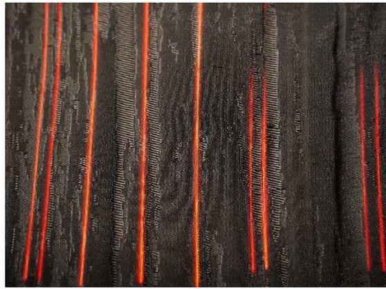
写真2・3 iOLED フィルム光源を織り込んだ西陣織 (15 cm×150 cm)
