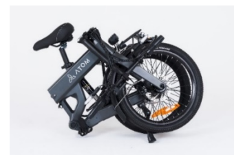
後輪車軸にモーター ペダルやチェーンはなし
