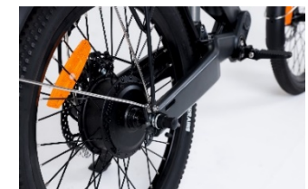
後輪車軸にモーター ペダルやチェーンはなし
