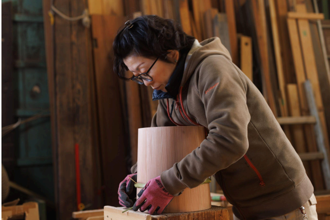
藤井製桶所を支える職人。一本一本竹箍(たけたが)を締め、木桶に命を吹き込む
